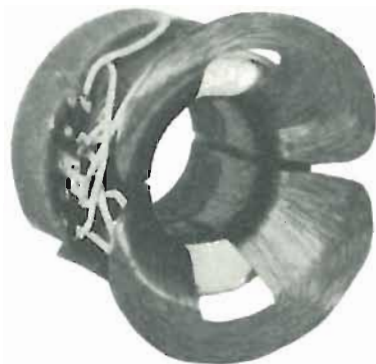
Fig. 3.9. - Le bobine di deflessione del giogo.
