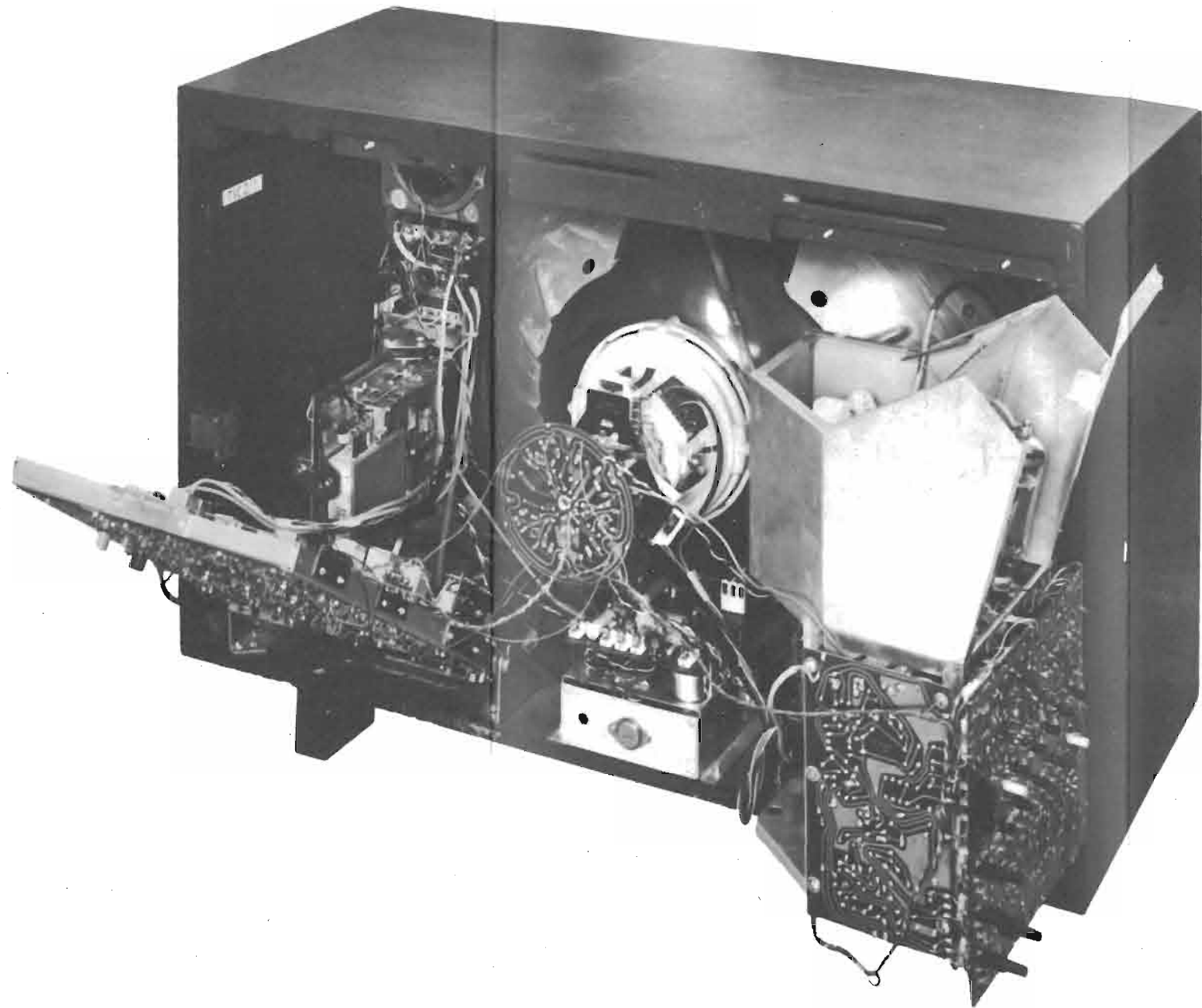
Tavola XXVIII — TELEVISORE A COLORI PHONOLA (FIMI) mod. TV 25 C 76/6 - Quarta parte - A sinistra, nell'interno è visibile il selettore integrato VHF-UHF; al centro, il cinescopio tricromatico con il pannello rotondo dei circuiti ausiliari, e sotto di esso l'alimentatore BT; a destra, di fronte
