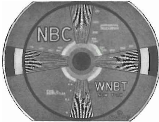
Fig. 6.8. - Monoscopio della NBC.
