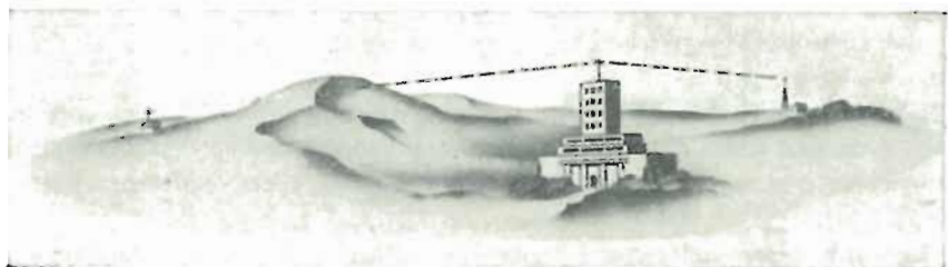
Fig. 17.7. - Le onde ultracorte irradiate dalle trasmittenti TV non superano gli ostacoli. A destra della trasmittente, la ricezione è possibile; a sinistra, la ricezione non è possibile, data la presenza della collina.
